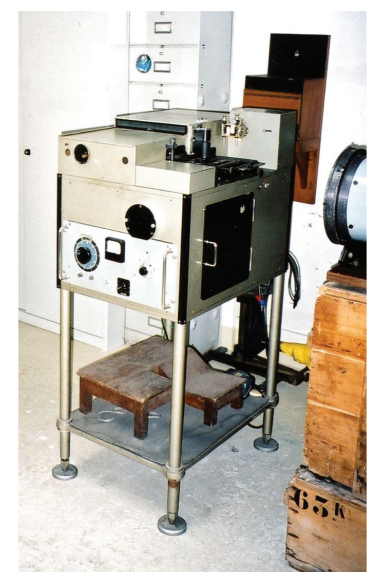
Figure 4 : Vue du microphotomètre construit par D. Chalonge destiné à lire les plaques photographiques produites par son spectrographe.
